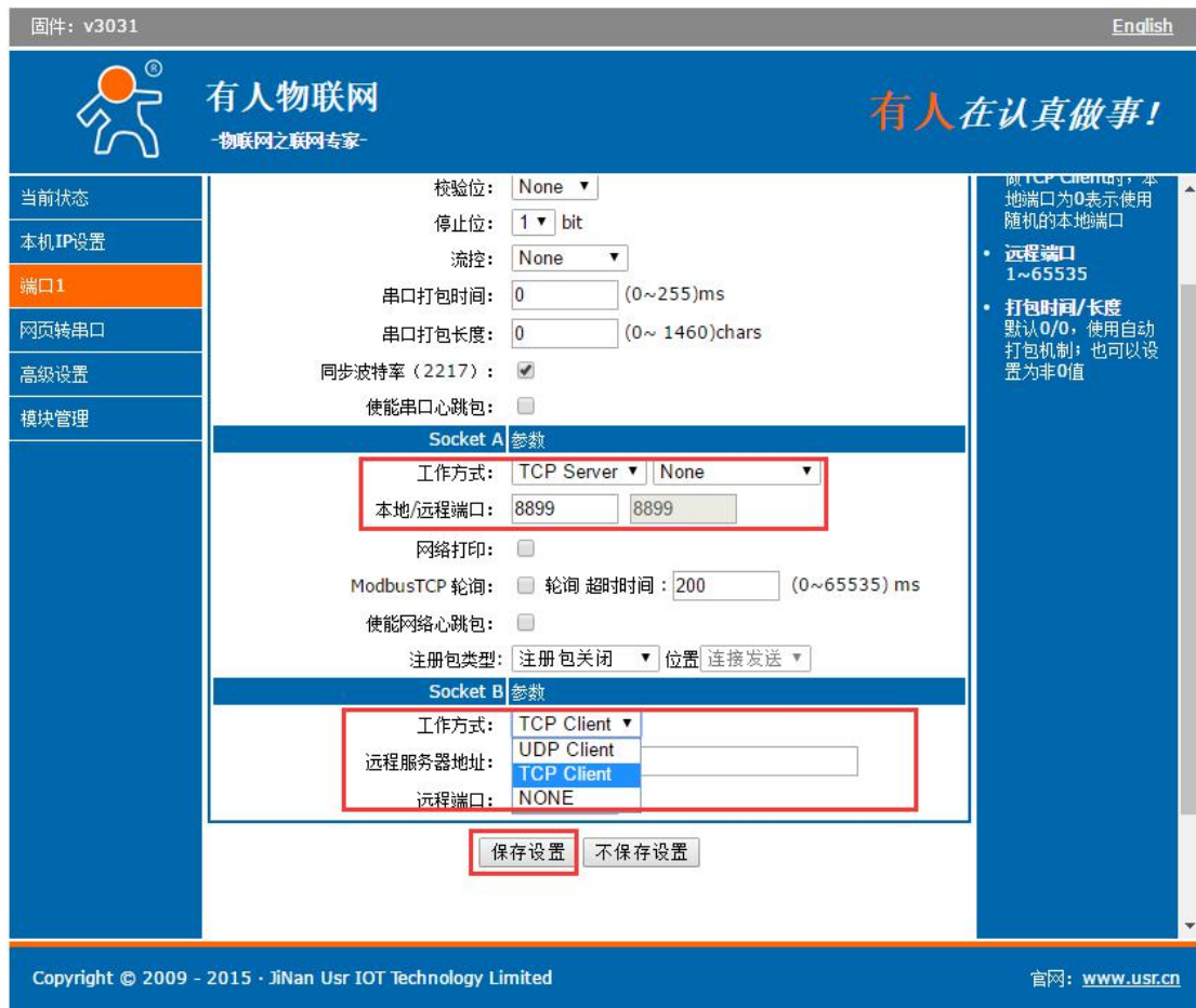
图 6 Socket A/SocketB 设置方法
