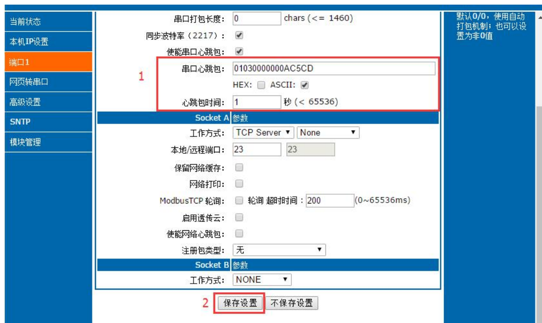
图 43 Modbusrtu 主动查询设置截图
